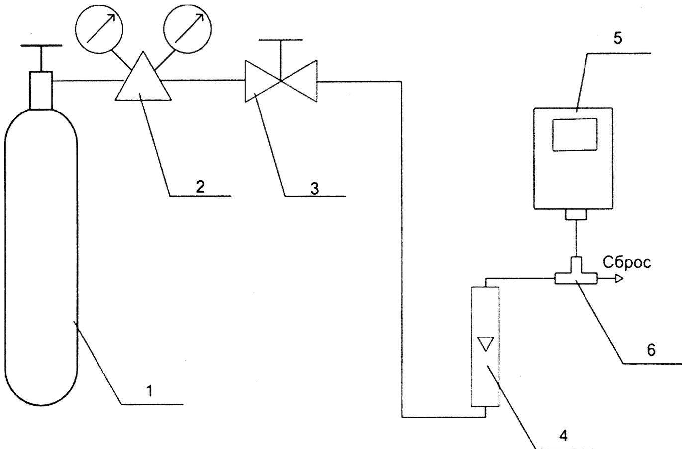
1 – источник ГС (баллон или ГГС); 2 – редуктор баллонный; 3 – вентиль точной регулировки трас-
