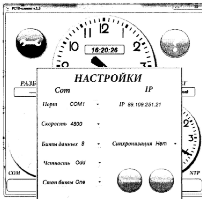
Рисунок 3 – Параметры порта RS-232 и IP адрес.
