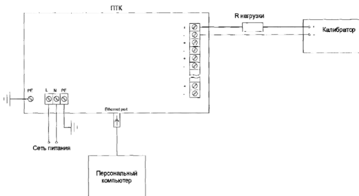
Рисунок 3 – Схема проверки диапазонов и определения погрешности воспроизведения силы постоянного тока ( R_{\text{нагрузки}} \leq 500 \text{ Ом} )
