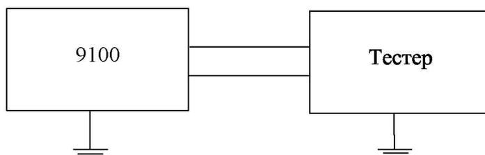
Рисунок 2 – Структурная схема определения погрешностей измерений напряжения и силы постоянного тока
