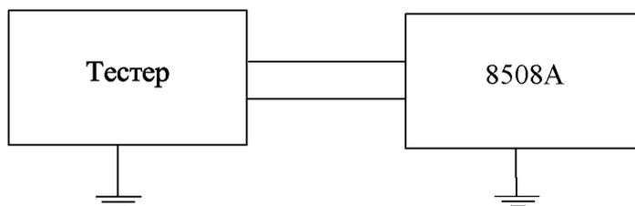
Рисунок 1 – Структурная схема определения абсолютных погрешностей воспроизведений напряжения (до 1000 В) и силы (до 2 А) постоянного тока
