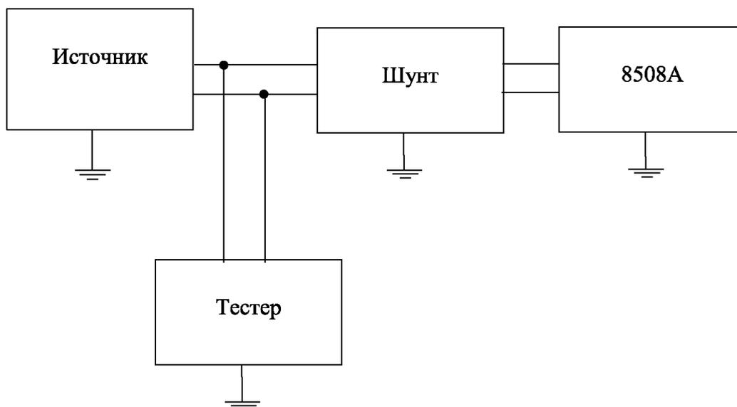
Рисунок 4 – Структурная схема определения погрешностей измерений силы постоянного тока модуля IPPS для испытательных сигналов свыше 20 А
