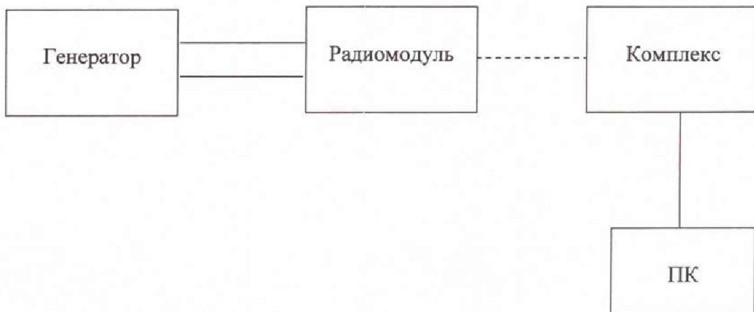
Рисунок 3 – Схема подключения для определения относительной погрешности измерения и преобразования количества импульсов электрического напряжения
