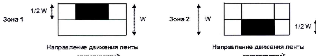
Рисунок 1 — Расположение испытательных нагрузок для СИ, осуществляющих взвешивание динамически
