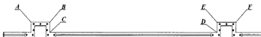
Рисунок 2 – Калибровочная линейка ДКП.999.15.061.00 с указанием контрольных точек
