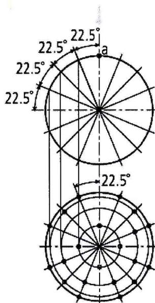
Рисунок 1 - Точки касания на сфере для определения допускаемой абсолютной погрешности измерительной головки, МРЕ<sub>Р</sub>
