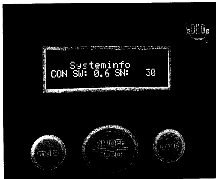
Рис. 1- Вид дисплея газоанализатора-течеискателя элегаза SF 6 -LeakSpy, модификаций 3-033-R200, 3-033-R 201 при отображении номера версии ПО.
