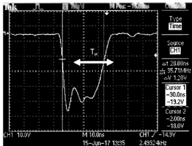
Рисунок 3 – Экран осциллографа при измерении длительности импульсов ГИВ.
