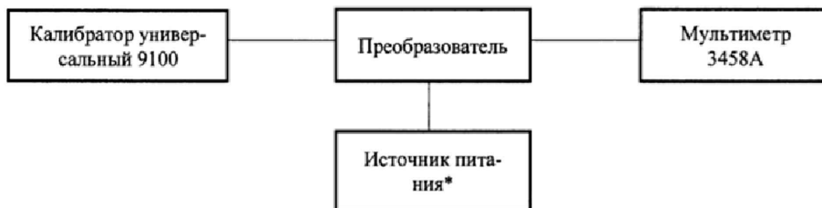
Рисунок 1 – Структурная схема определения погрешности преобразования напряжения постоянного тока, напряжения переменного тока, силы постоянного тока от 0 до 20 А, силы переменного тока, электрического сопротивления, термодпары, термопреобразователя сопротивления
