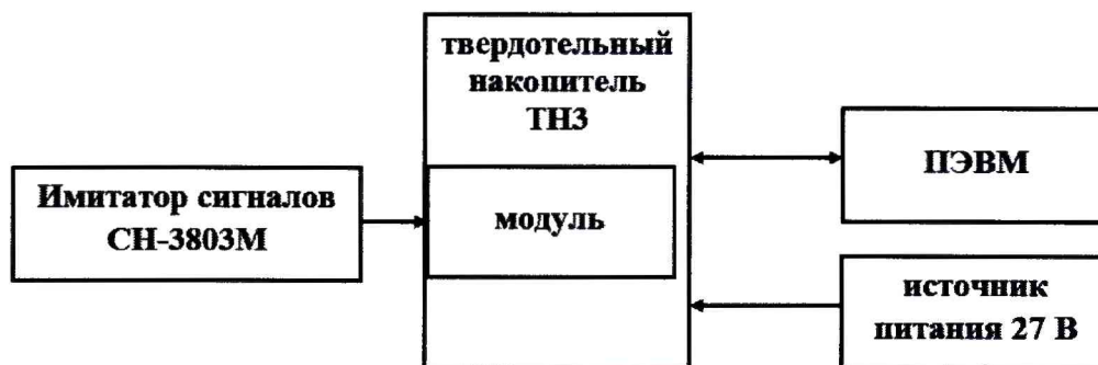
Рисунок 1 Схема для проведения измерений при проверке работоспособности
