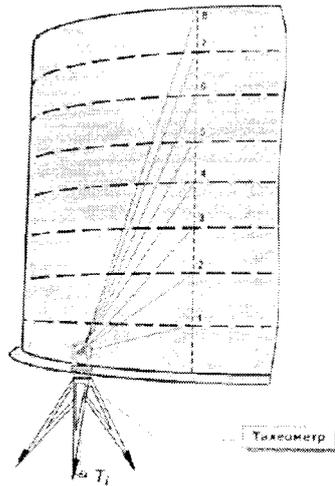
Рисунок А.4 Определение абсолютной высоты поясов тригонометрическим нивелированием
