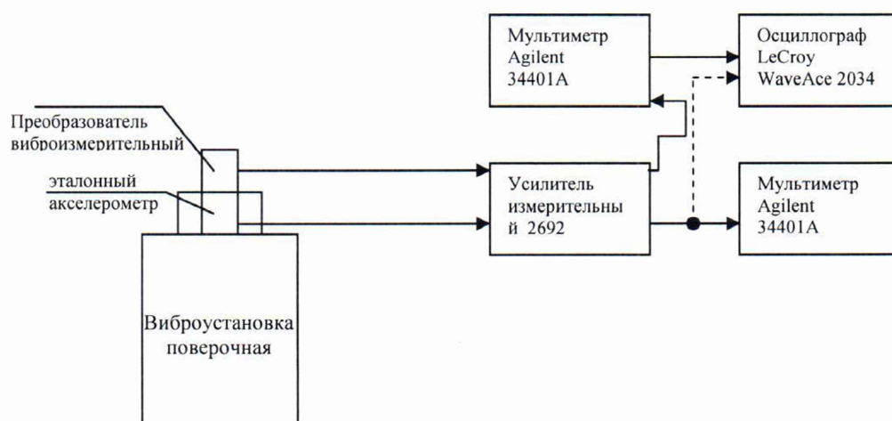
Рисунок 1 – Схема подключения преобразователя виброизмерительного при проведении поверки
