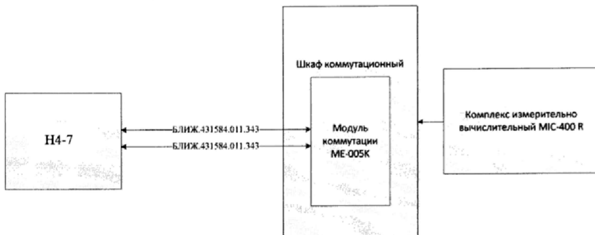
Рисунок 15 - Схема поверки электрической части ИК температуры
