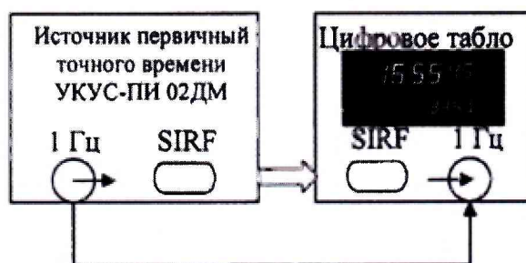
Рисунок 1 – схема подключения УКУС-ПИ 02ДМ
