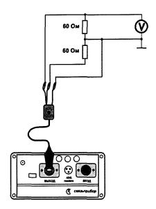
Измерения производятся поочередно для всех частот основного списка в режиме узкополосного измерения уровня.
