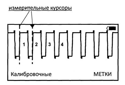
Установите ручку сопротивления согласования Z0 в крайнее правое положение, добившись наиболее четкой формы калибровочных меток. С помощью кнопок «растяжка», «▲» и «▼» установите значение растяжки 002.
