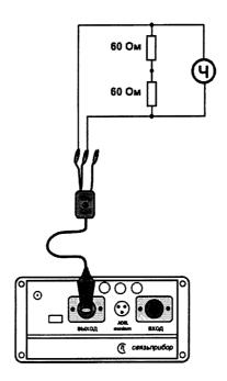
Для измерения частоты сигнала генератора подайте сигнал с выхода генератора прибора на вход частотомера (вход частотомера 1:10).
