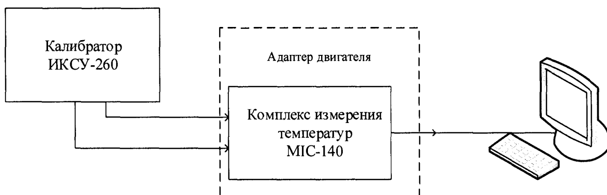
Рисунок 15 – Схема поверки ИК напряжения постоянного тока
