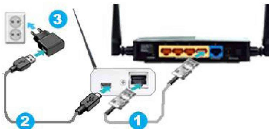
Рисунок 2.3 – Подключение менеджера WST-EMT к беспроводному Wi-Fi-Интернету
