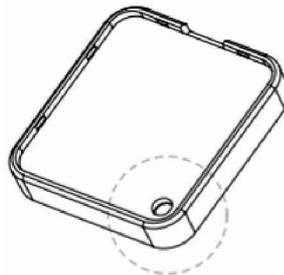
Рисунок 2.10 – Установка платы тега в крышке футляра корпуса
