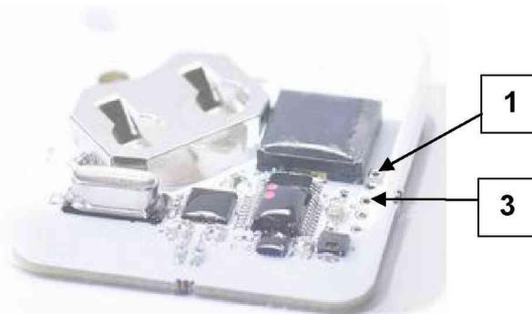
Рисунок 2.131 – Контакты на плате тега, которые необходимо замкнуть проводником для исполнения операции аппаратной очистки флэш-памяти тега
