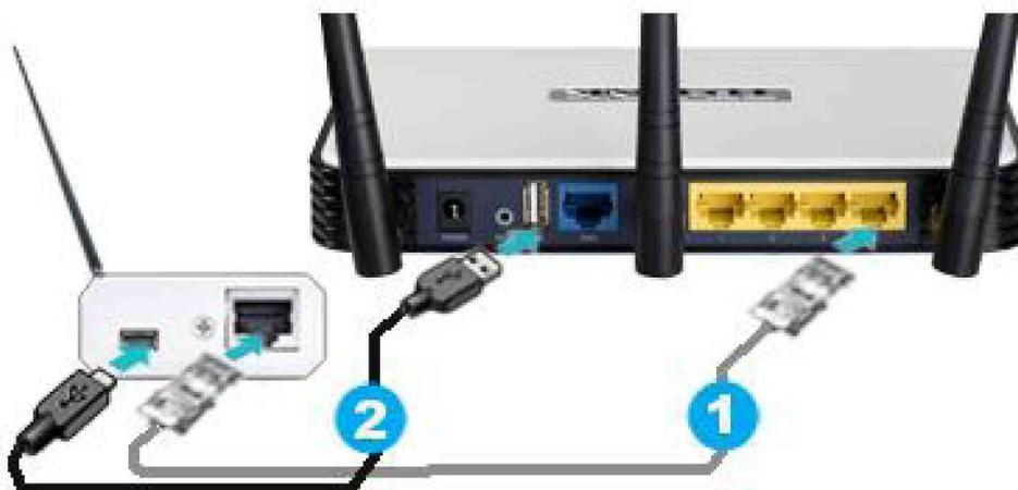
Рисунок 2.4 – Подключение менеджера WST-EMT к беспроводному Wi-Fi-Интернету
