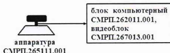
Рисунок 1 - Схема для проведения измерений при проверке работоспособности и определения погрешности определения координат местоположения
