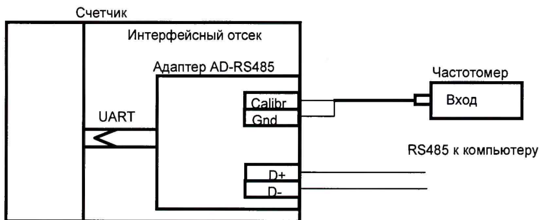
Рисунок 1 – схема подключения частотомера
