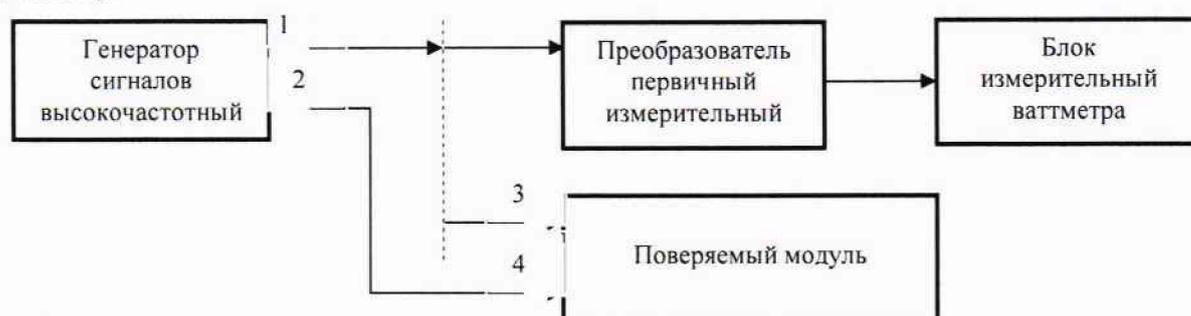
Обозначения: 1 - выход сигнала генератора E8257D; 2 - выход сигнала синхронизации "1 GHz Out" генератора E8257D; 3 - вход измеряемого сигнала модуля; 4 - вход "Clock In" синхронизации осциллографа.
