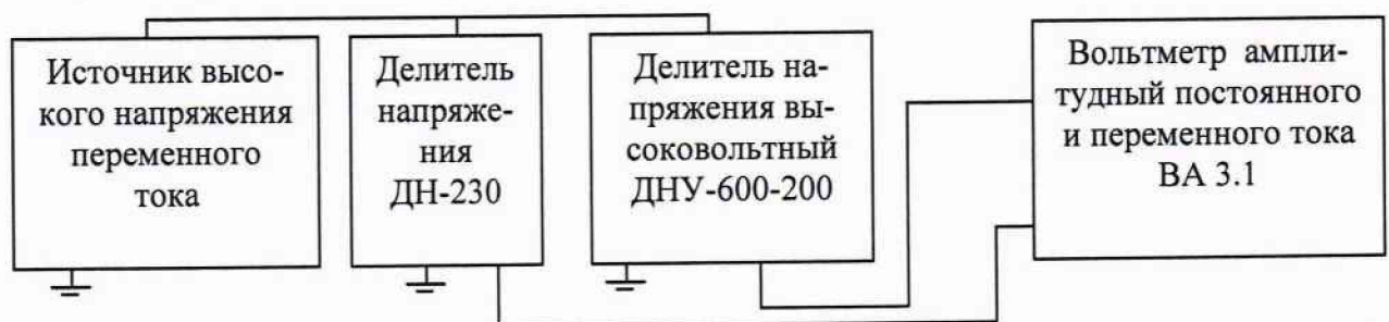
Рисунок 1 - Схема проверки относительной погрешности коэффициента масштабного преобразования напряжений переменного тока промышленной частоты
