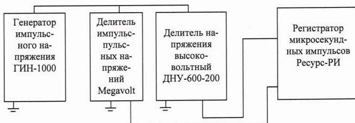
Рисунок 2 - Схема проверки относительной погрешности измерений коэффициента масштабного преобразования напряжений стандартизированных грозовых и коммутационных импульсов
