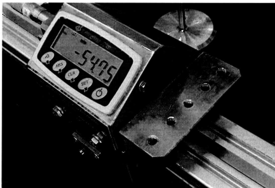
Рисунок 5 – Переходник для крепления стойки отражателя луча интерферометра
