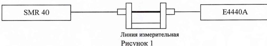
Установить на выходе генератора SMR 40 сигнал частотой 400 МГц с амплитудой 200 мВ.
