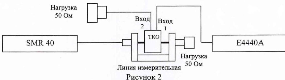
Вход 1 ответвителя соединить кабелем SMA-N из состава ответвителя с входом анализатора спектра E4440A, а вход 2 с согласованной нагрузкой.
