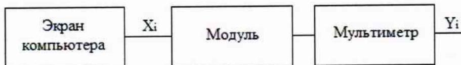
Рисунок 3 - Схема подключений при определении погрешностей ИК, реализующих линейное цифро-аналоговое преобразование сигналов силы и напряжения постоянного электрического тока
