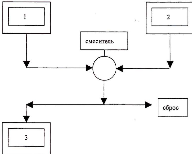
Рисунок 1 – Газовая схема для определения основной погрешности газоанализатора
