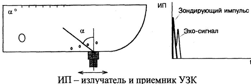
Рисунок 19 – Определение мертвой зоны при использовании ручных ПЭП
