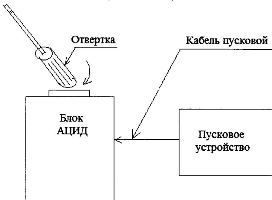
Рисунок А.1 – Схема подключения блока АЦИД при опробовании
