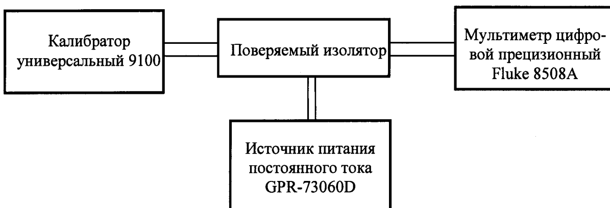
Рисунок 1 – Структурная схема опробования и определения абсолютной основной погрешности преобразований
