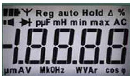
Рисунок 10.3 - Рабочее поле индикатора мультиметра
