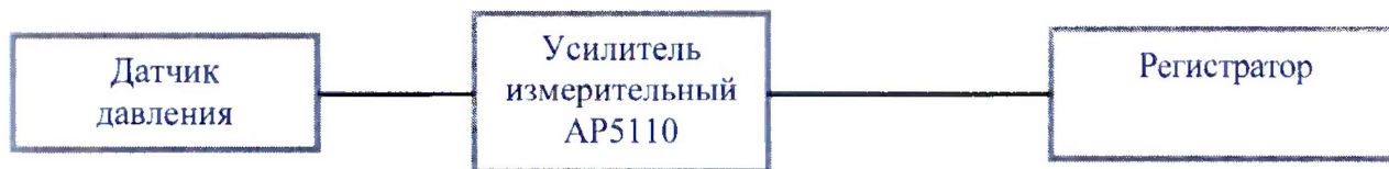
Рисунок Б.1 – Схема внешних электрических соединений модификаций датчика PS09, PS09-01
