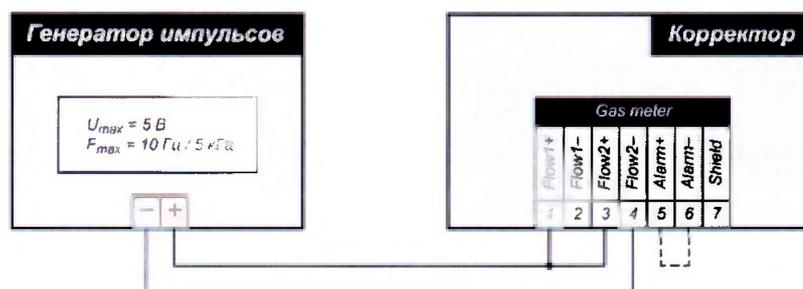
Рисунок 1 – Схема проверки входов счётчика газа
