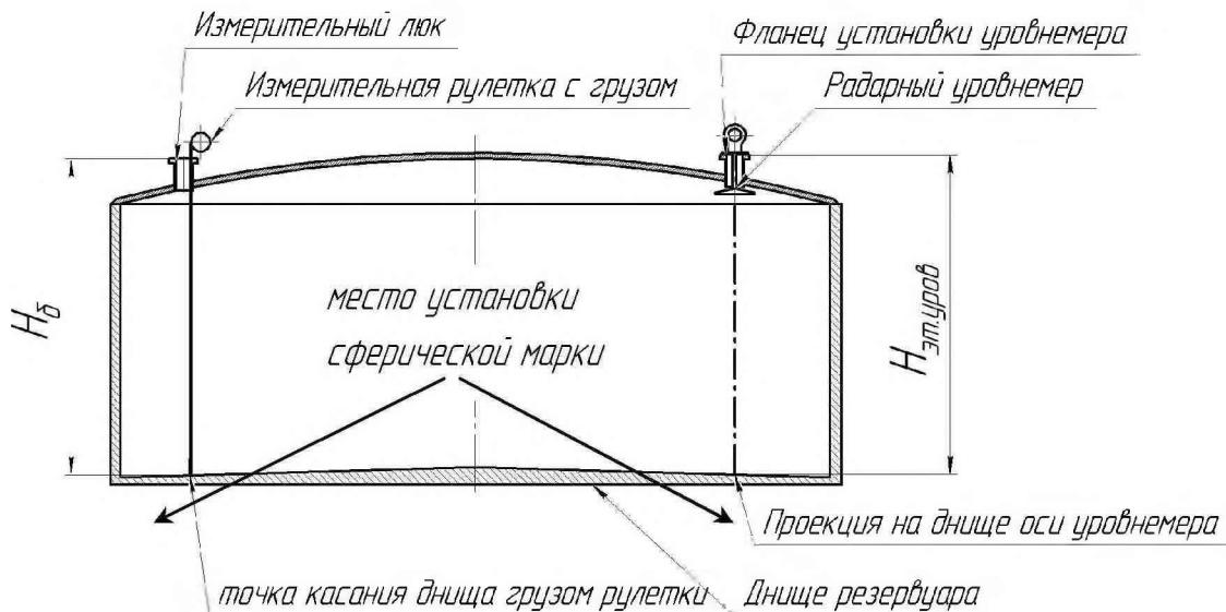
Рисунок А.1 – Схема измерения базовой высоты резервуара и эталонного расстояния
