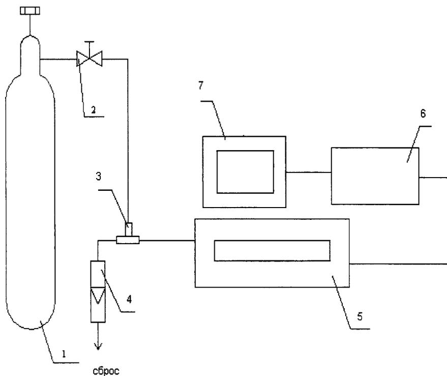
1 – баллон с ГГС; 2 – вентиль точной регулировки; 3 - тройник; 4 – индикатор расхода (ротаметр);
