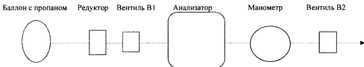
Рис 1. Схема подключения дополнительного оборудования к анализатору при измерении температуры конденсации углеводородов.
