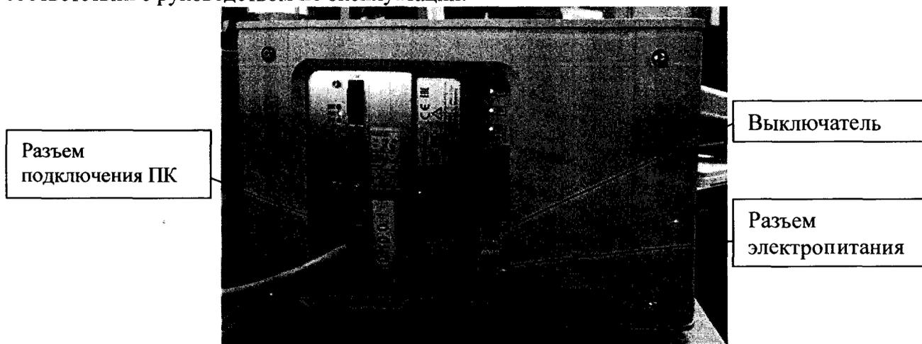
Рисунок 1 - Задняя панель спектрометра
