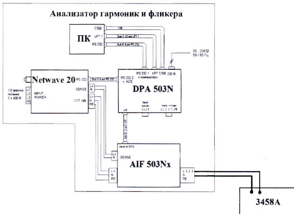
Рисунок 5 – Схема подключения к измерительному блоку для проверки режимов воспроизведений трехфазного измерительного блока DPA 503N
