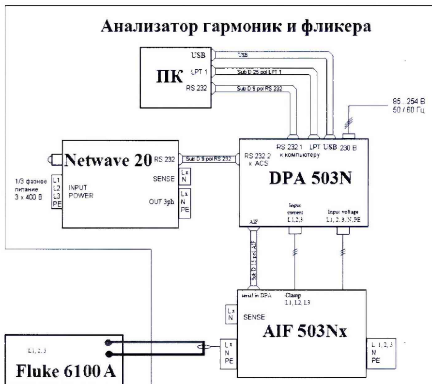
Рисунок 3 – Схема подключения к измерительному блоку для проверки режима измерений силы переменного тока трехфазного измерительного блока DPA 503N
