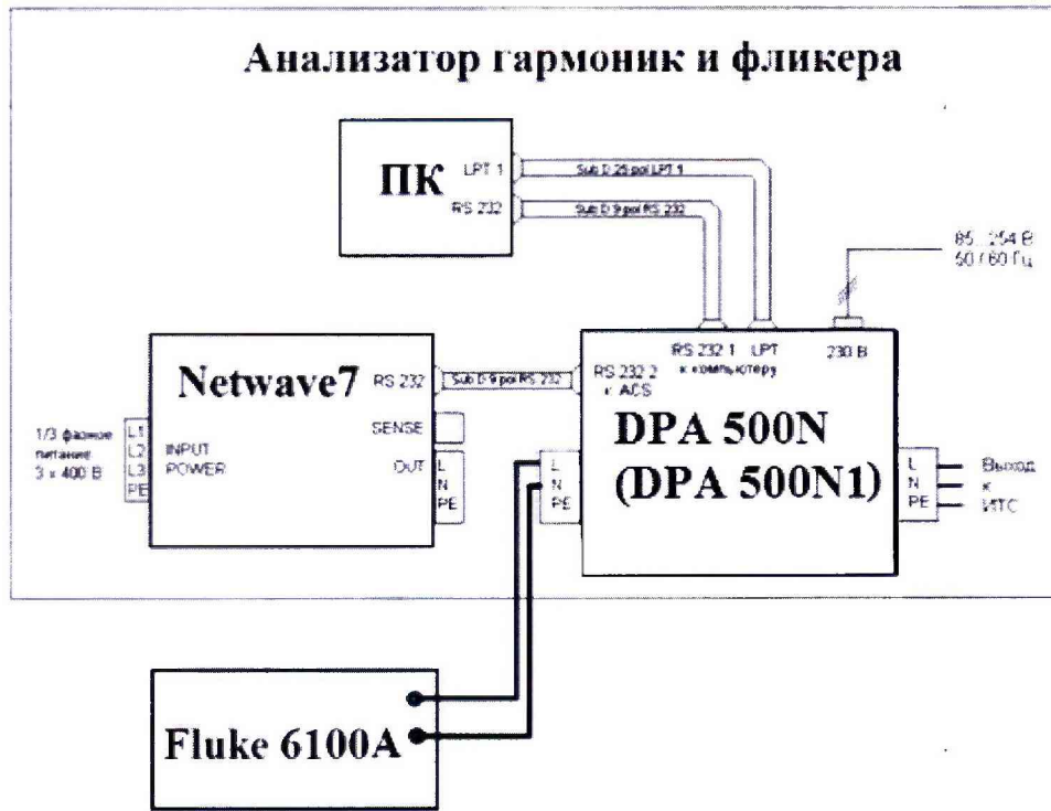
Рисунок 1 – Схема подключения к измерительному блоку для проверки режимов измерений однофазного измерительного блока DPA 500N (DPA 500N1)
