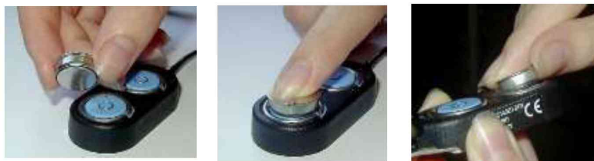
Рисунок 2.8 – Операции установки регистратора в гнездо приемного зонда
