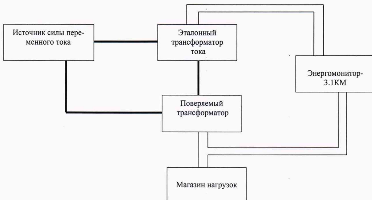
Рисунок 1 – Структурная схема определения погрешностей
