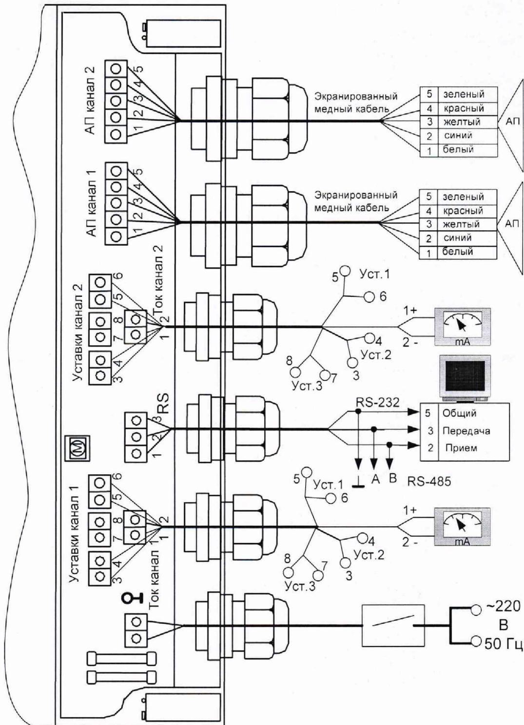
ЭСКИЗ МОНТАЖА АП-11 ДЛЯ ИЗМЕРЕНИЯ РАСХОДА В ТРУБЕ
