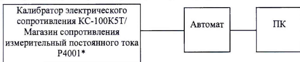
Рисунок 1 – Схема структурная определения основной относительной погрешности измерений электрического сопротивления изоляции
