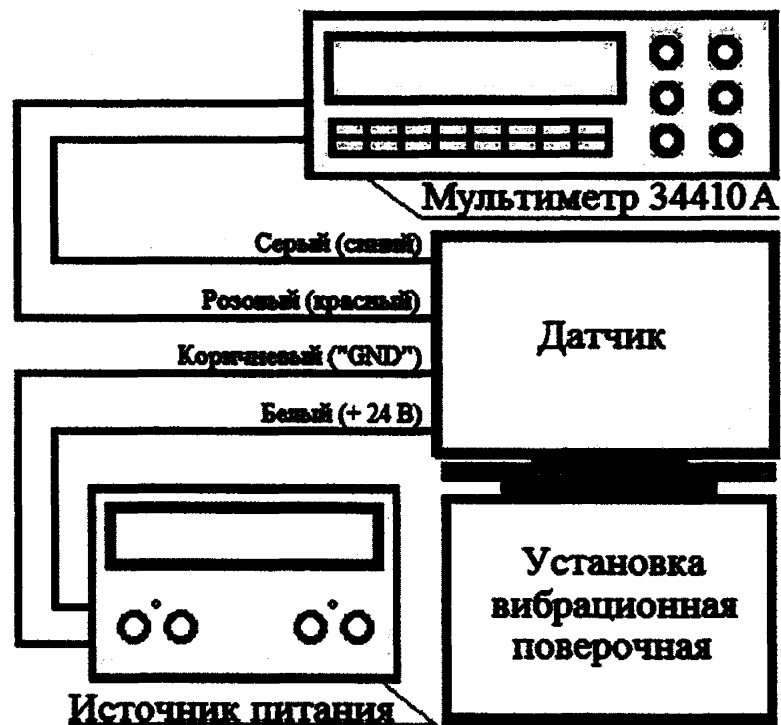
Рисунок 2 – Схема измерений при проверке установленного порога срабатывания
