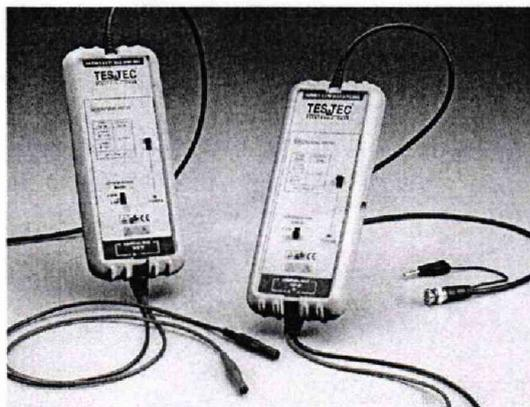
Рисунок 3 – Пробник-делитель для определения уровня пульсаций
