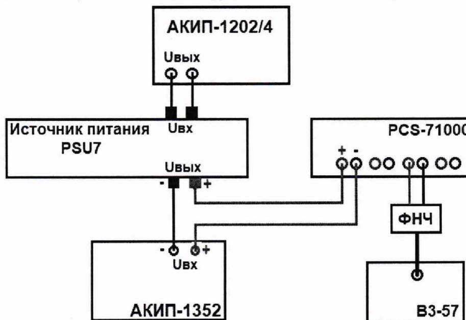
Рисунок 5 – Схема соединения приборов для определения пульсаций силы постоянного тока
