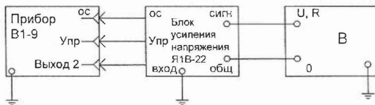
Рисунок 8 - Схема электрическая структурная подключения приборов для определения основной погрешности измерения напряжения переменного тока синусоидальной формы до 100V
