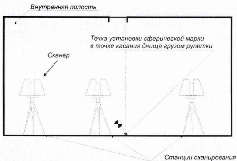
Рисунок А.2 – Схема сканирования внутренней полости резервуара
