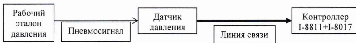
Рис.4 - Схема подключения средств испытаний к ИК избыточного давления и разрежения жидкости и газа.
