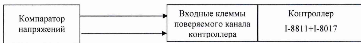
Рис.8 - Схема подключения компаратора напряжений к ИК напряжения постоянного тока общего назначения
