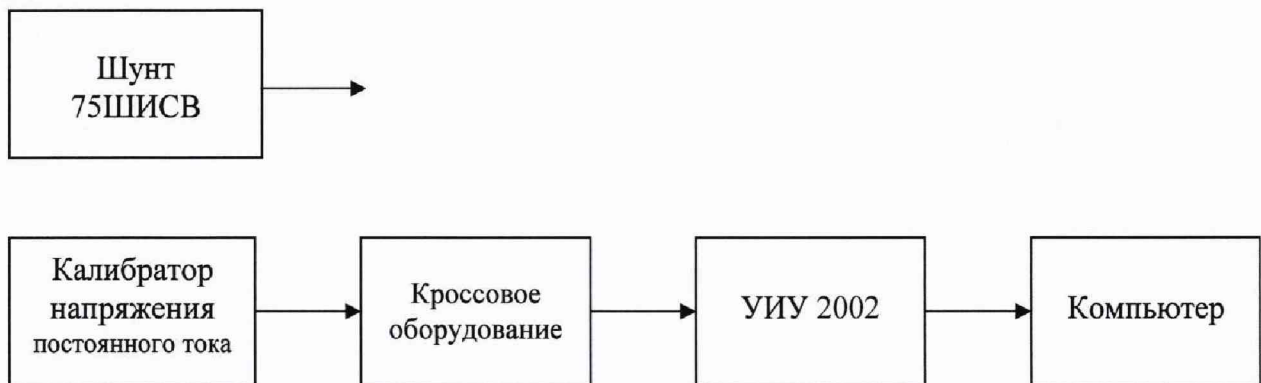
Рисунок Б.10 - Схема определения метрологических характеристик ИК силы постоянного тока
