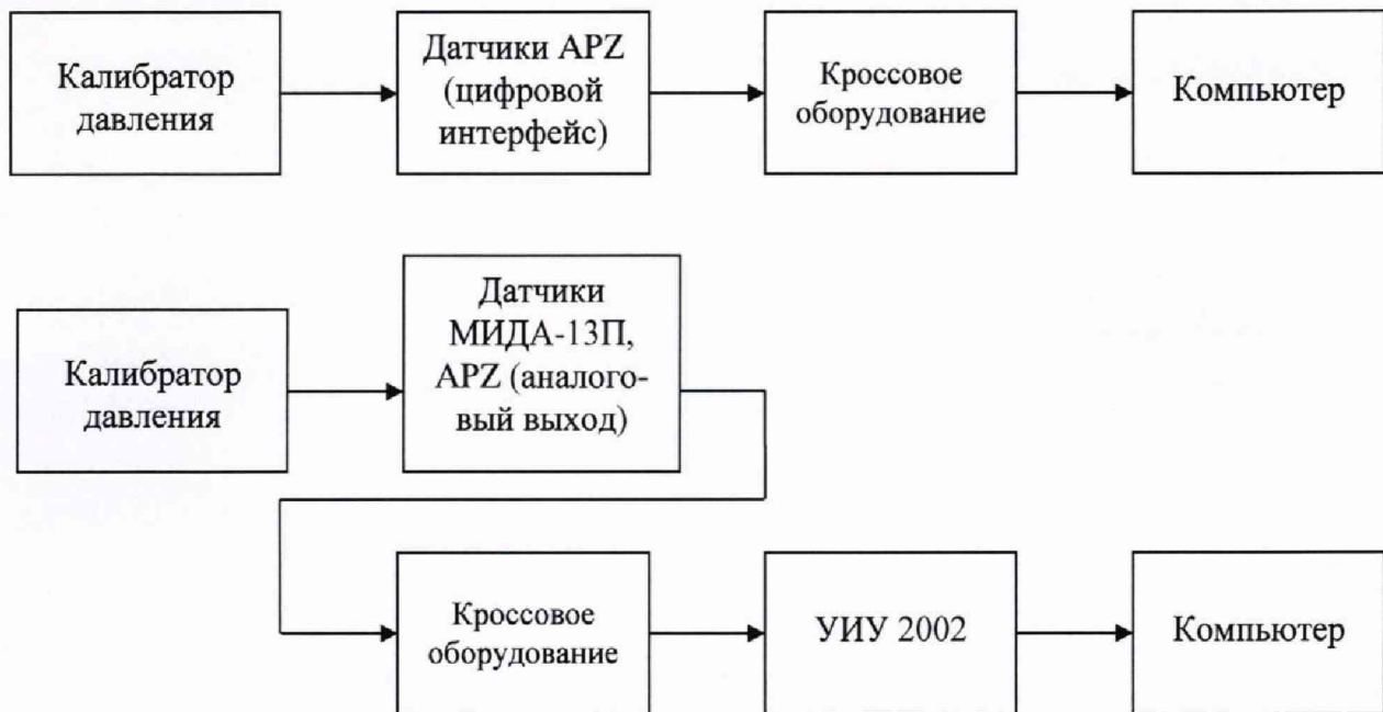
а) Схема определения метрологических характеристик комплектным способом
