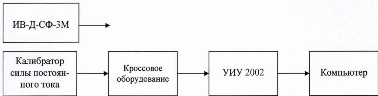
Рисунок Б.6 - Схема определения метрологических характеристик ИК виброскорости
