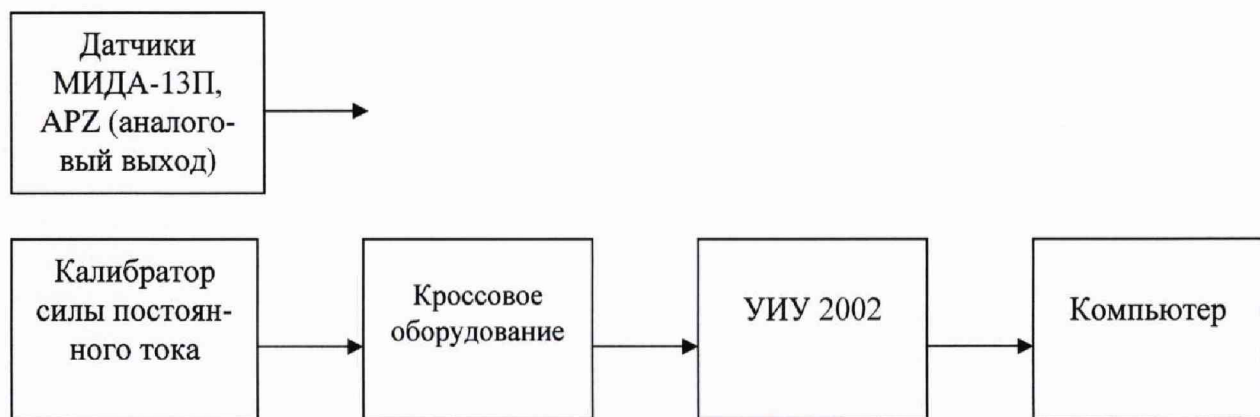
б) Схема определения метрологических характеристик поэлементным способом
