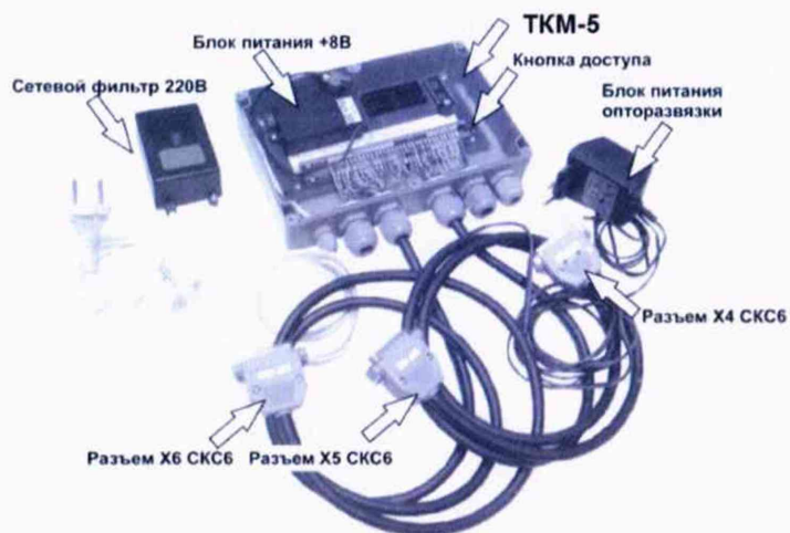
Рис. Б.3 Внешний вид ТКМ-5 Технологический коммутационный модуль ТКМ-5 поставляются изготовителем вычислителя по отдельному заказу
