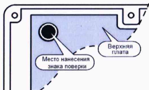
Рис. Б.5 Место нанесения знака поверки - на крепежный винт защитного корпуса электронного модуля (р.12.4 РЭ)
