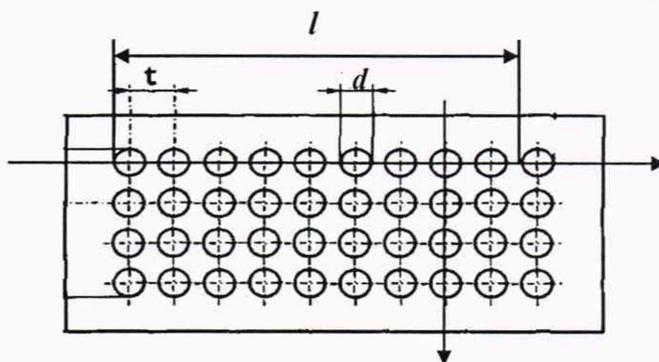
Рисунок 2 – полотно с прямыми рядами отверстий
