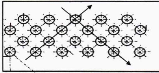
Рисунок 3 – полотно со смещенными рядами отверстий
